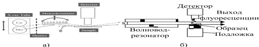
Рис. 1 Сравнение рентгенооптических схем традиционного РФА ПВО (а) и РФА ПВОВР (б)
